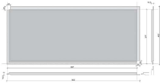
Joonis 1 WALDESIGN dekoratiivsed elemendid 16,5 mm (+/- 0,5 mm)
